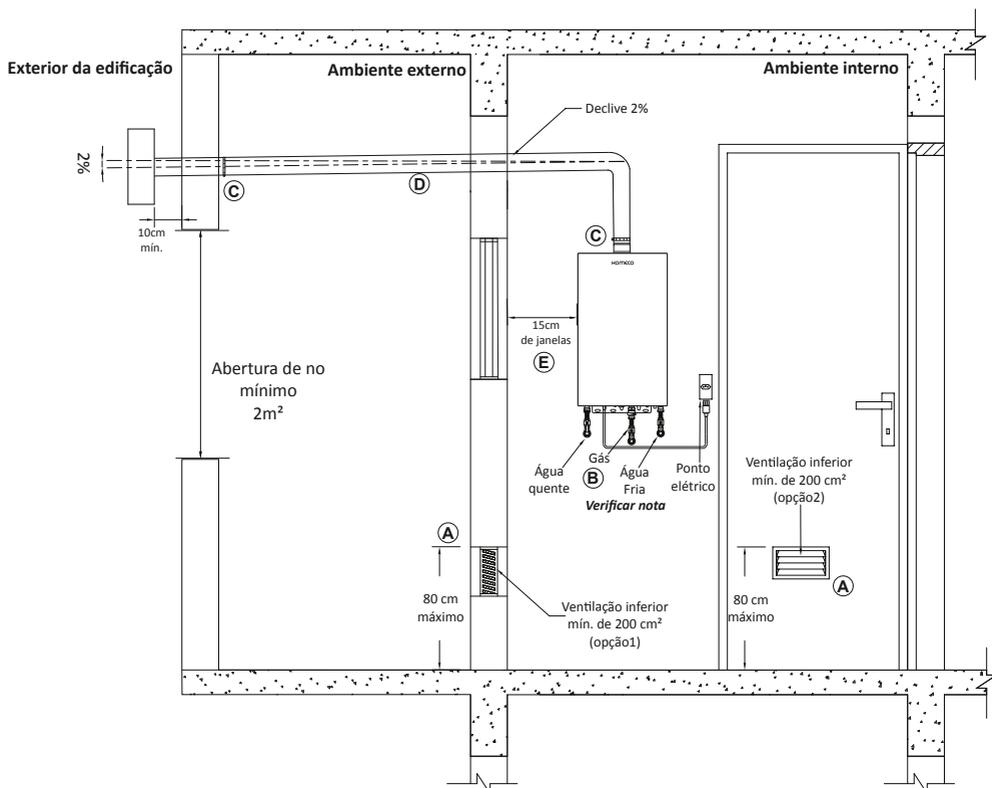
**(A)** Área de ventilação inferior permanente mínima de 200cm<sup>2</sup> conforme norma NBR13103, respeitando altura máxima de 0,80m do piso acabado;
