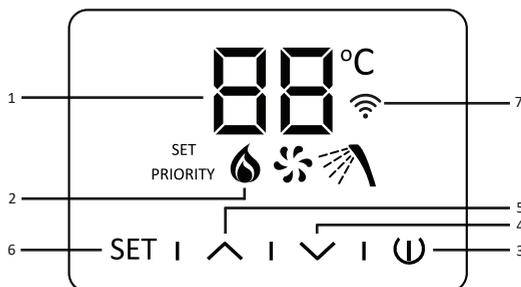
**1. Temperatura selecionada e código de erro.** Indica a temperatura selecionada e os códigos de erro segundo tabela Códigos de Falha. A temperatura que aparece no display é a da temperatura de saída de água. Sempre que é ajustado a temperatura aparecerá a temperatura esperada, logo após voltará a indicar a temperatura de saída da água.
