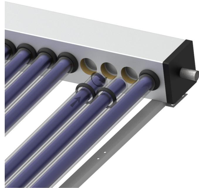
Insira o tubo na região interna do manifold até que a região inferior do tubo se torne possível o encaixe no suporte de tubos. Após a montagem do tubo, retorne faça o movimento contrário, até que o tubo encaixe no suporte de tubos.
