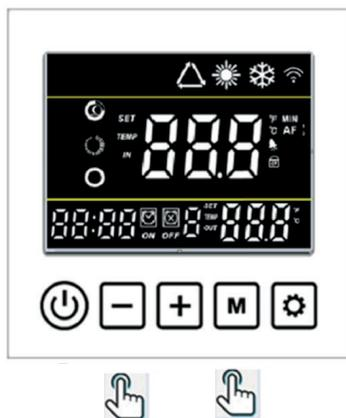
Segure e por 5 segundos e quando a temperatura da tubulação estiver abaixo da temperatura de descongelamento da saída, o sistema estará habilitado para entrar em descongelamento manual.
