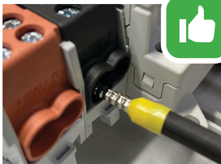
CRIMPAGEM CORRETA EXEMPLO CORRETO DE CONEXÃO
