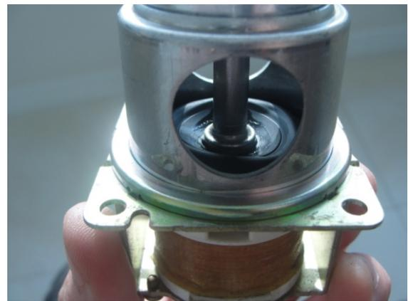
**2, Fotos de camara de combustão após funcionar com ação de oleína e válvula proporcional após sofrer ação de oleína**
