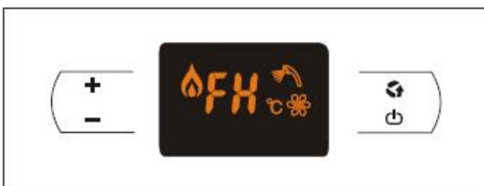
Pressione “+”, o display apresentará o código “FH”, pressione o botão “Liga/desliga” pressione “+” ajuste o parâmetro de “FH” conforme tabela de configuração de pressão secundária. Finalizando o ajuste pressione “Liga/Desliga” voltando ao “FH”;
