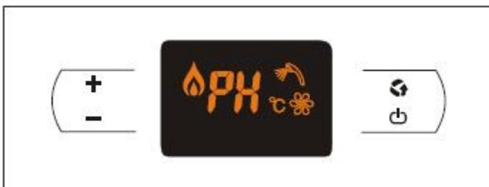
Pressione “+”, o display apresentará o código “PH” (caso o aparelho esteja com passagem de água ele ligará), pressione o botão “Liga/desliga” pressione “+” ajuste o parâmetro de “PH” conforme tabela de configuração de pressão secundária. Finalizando o ajuste pressione “Liga/Desliga” voltando ao “PH”;
