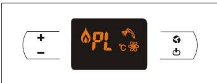
Pressione “+”, o display apresentará o código “PL”, pressione o botão “Liga/desliga” pressione “+” ajuste o parâmetro de “PL” conforme tabela de configuração de pressão secundária. Finalizando o ajuste pressione “Liga/Desliga” voltando ao “PL”;
