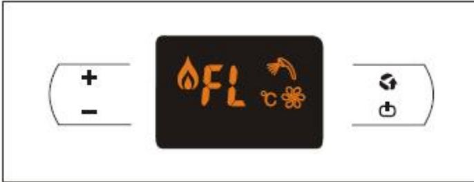
Pressione “+”, o display apresentará o código “FL”, pressione o botão “Liga/desliga” pressione “+” ajuste o parâmetro de “FL” conforme tabela de configuração de pressão secundária. Finalizando o ajuste pressione “Liga/Desliga” voltando ao “FL”;
