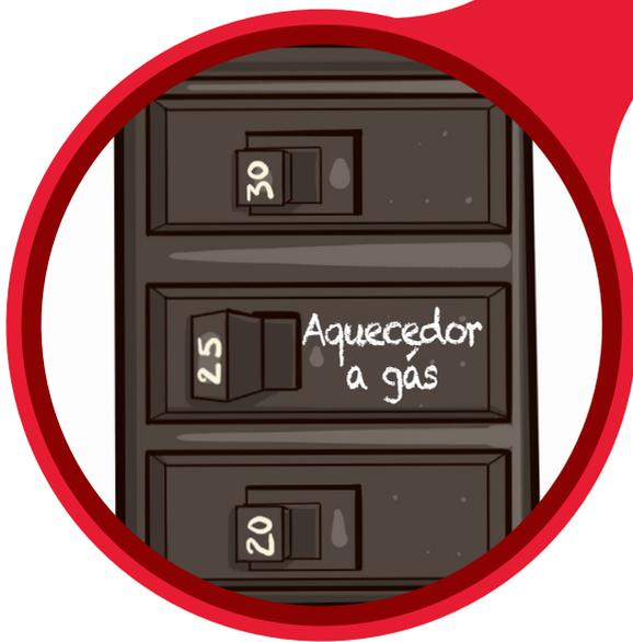
**7** Para a alimentação elétrica do resistor, providencie uma rede independente, com disjuntor e fiação exclusiva. Mantenha o termostato de controle em boas condições para evitar superaquecimento da água.
